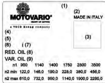
**Placa motorreductor (colocada en el motor)**
