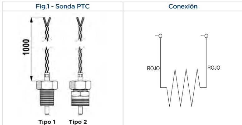
Si se suministra en el kit adjunto, sustituir el tapón de cierre con la sonda PTC en la posición de montaje evidenciada por los relativos esquemas.
